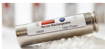
Prototype batterie Na-ion format 18650 (Journal CNRS, 2015)
